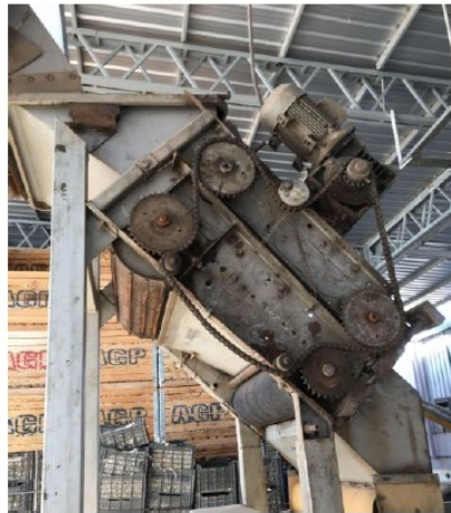
Rodillos para desarmar la cabeza del ajo
