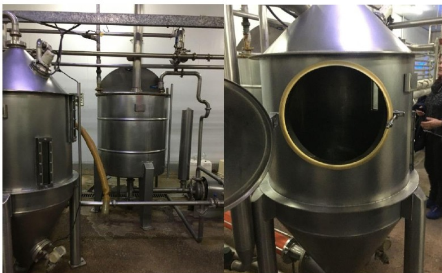
Filtros de acero inoxidable donde se transporta la pasta para el pasteurizado
