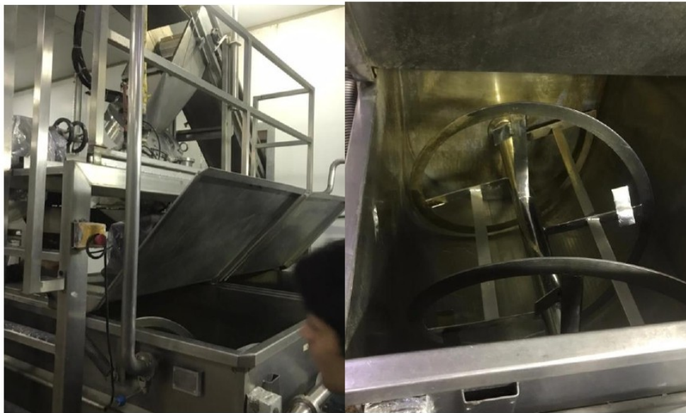
Mezclador. Se incorpora el ácido y agua junto con el ajo triturado
