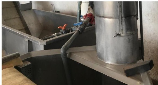
Destoner. Primer contacto del ajo con el agua
