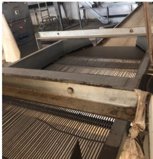
zaranda vibratoria, primera limpieza del ajo
