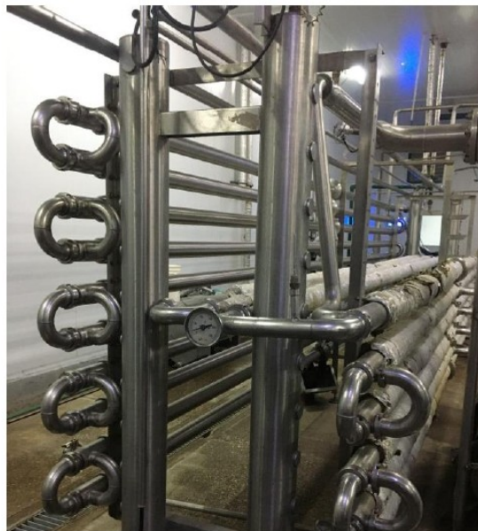
Tubos donde se transporta la pasta ya pasteurizada
