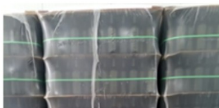
Fleje (cinta plástica verde que rodea las botellas antes de iniciar su recorrido por la línea de producción)
