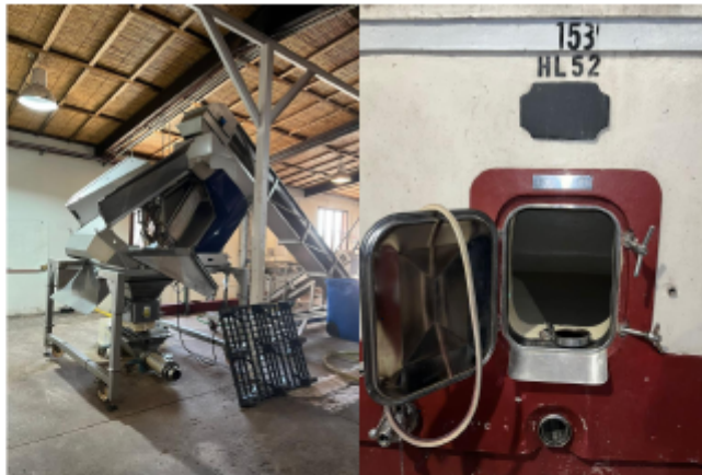
(1) Máquina Despalilladora Bucher. (2) Tanques de hormigón recubiertos de epoxi
