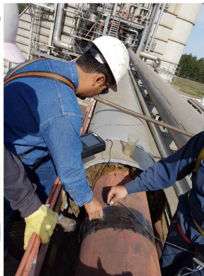
Medidores de espesor por ultrasonidos (izquierda) e inspección de soldadura por ultrasonidos (derecha).
