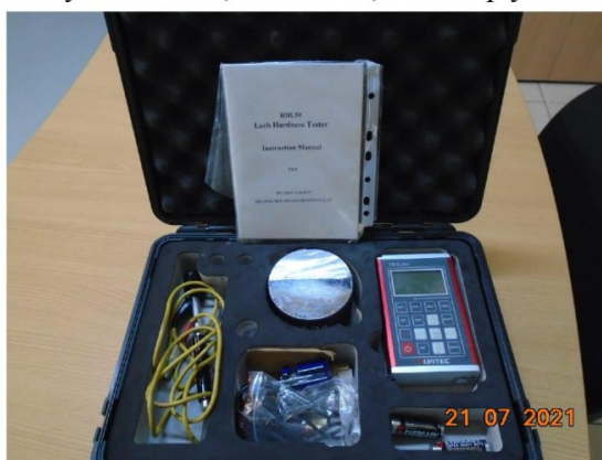
Medidor de durezas de materiales
