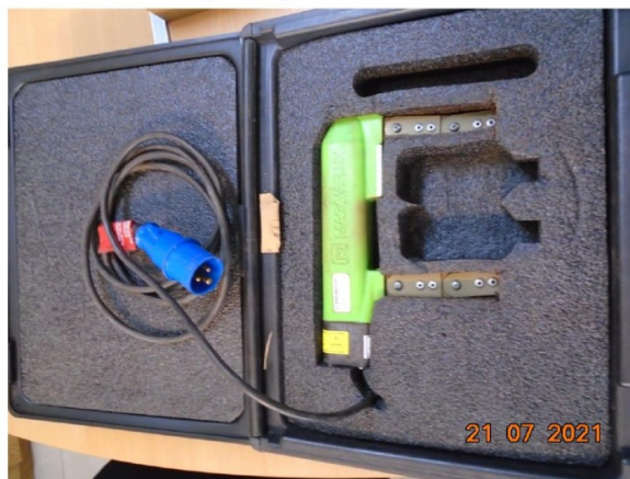
Yugo electromagnético detector de fisuras.
