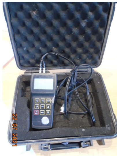
Medidores de espesor por ultrasonidos (izquierda) e inspección de soldadura por ultrasonidos (derecha).
