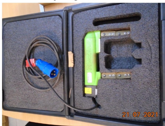
Yugo electromagnético detector de fisuras.
