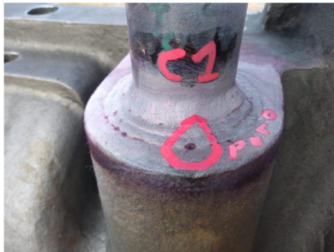
Ensayo de líquidos penetrantes para detección de fallas (izquierda) y lámparas de UV (derecha)
