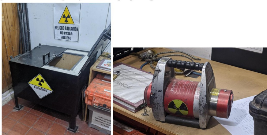
Depósito de almacenamiento (izquierda) y equipo portátil de gammagrafía (derecha).
