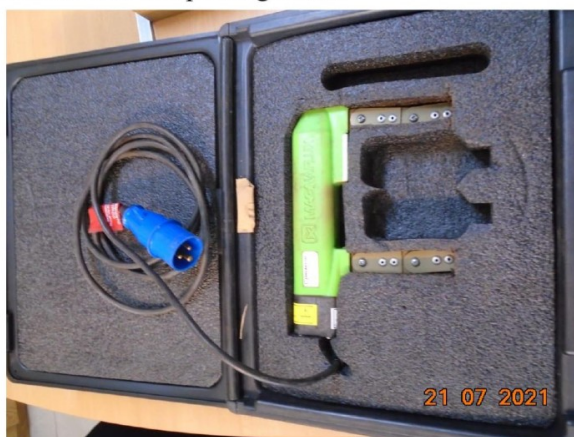
Yugo electromagnético detector de fisuras.
