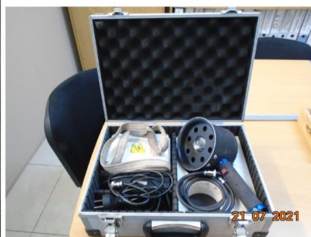
Ensayo de líquidos penetrantes para detección de fallas (izquierda) y lámparas de UV (derecha)
