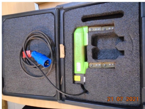
Yugo electromagnético detector de fisuras.
