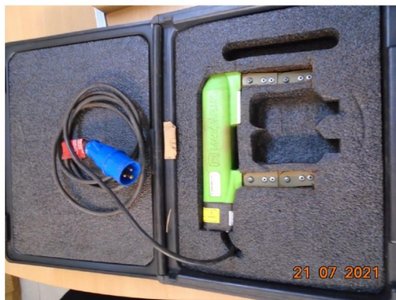
Yugo electromagnético detector de fisuras.
